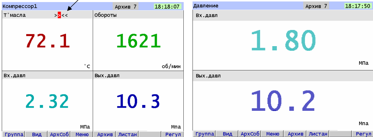
Рисунок 6.5 – Пример отображения текущих значений в виде цифрового табло
